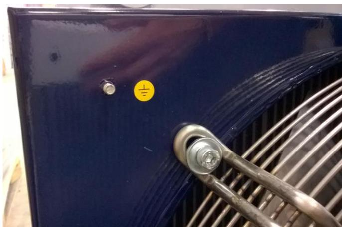
Una volta realizzato il collegamento, verificare la bontà dell'intervento misurando con un voltmetro/multimetro l'effettivo valore della resistenza terra/scambiatore (che deve essere inferiore al valore sopra indicato) prima di mettere in funzione l'apparecchiatura.
